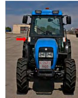
Luz delantera: dos o cuatro luces de color blanco, situadas en los bordes exteriores del vehículo
