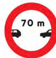
La distancia de seguridad puede estar marcada, en ciertos tramos de carretera, por esta señal (R-300) que prohíbe circular sin mantener con el vehículo precedente una separación igual o mayor a la indicada en la señal, excepto para adelantar.
