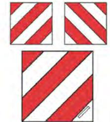
Cuando la carga sobresalga longitudinalmente por toda la anchura de la parte posterior del vehículo, se colocarán transversalmente dos paneles, cada uno en un extremo de la carga. Estos dos paneles se colocarán de tal manera que formen una geometría en V invertida con franjas alternas rojas y blancas.
