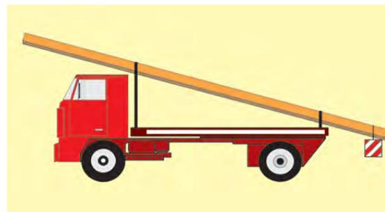
**Cuando sobresalga lateralmente del gálibo del vehículo,** de forma que sobresalga más de 0,40 metros del borde exterior de la luz delantera o trasera de posición del vehículo, deberá estar señalizada en cada una de sus extremidades laterales, entre el ocaso y la salida del sol o bajo condiciones meteorológicas o ambientales que disminuyan sensiblemente la visibilidad, con la siguiente señalización:
