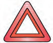
Se colocarán, uno por delante y otro por detrás del vehículo o la carga, como mínimo a 50 metros de distancia y en forma tal que sean visibles desde 100 metros, al menos, por los conductores que se aproximen.
