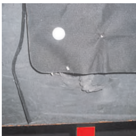
Impactos sobre la plancha balística.
